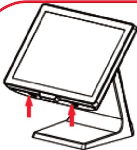
**1** Выключите POS-терминал и откройте крышку интерфейса.
