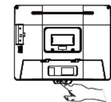
Кнопка включения питания терминала находится снизу под экраном
