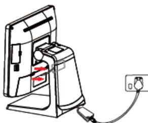
Чтобы установить/снять кабель питания:
